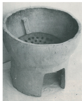
Le foyer céramique adapté au charbon
