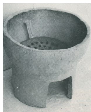
Le foyer céramique adapté au charbon
