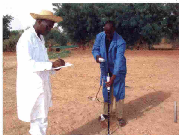
Mesure de l'humidité du sol avec la sonde TDR
