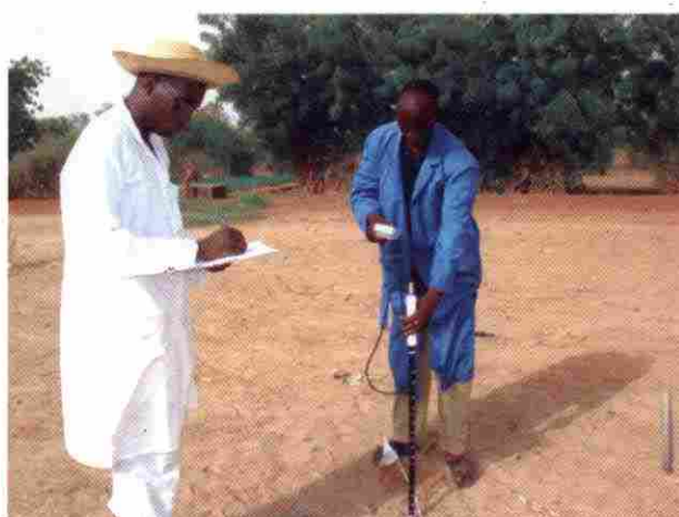
Mesure de l'humidité du sol avec la sonde TDR
