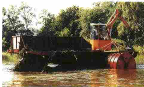
Véhicule amphibie à pneus ballons, également flottant
