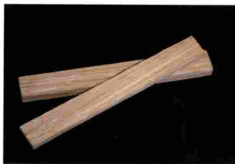
Ersatz de bois de construction en typha (Tiges de typha collées)
