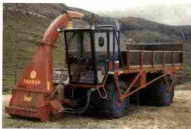
Véhicule amphibie à pneus ballons, également flottant
