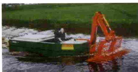
Bateau faucardeur à chargeur frontal et moteur à double hélice
